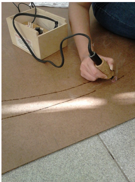
Figura 4: Utilização do Pirografo na placa de madeira. FONTE: Autores (2015)
