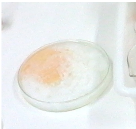
Figura 4: Desnaturação da proteína do ovo de galinha com a adição do álcool etílico.
